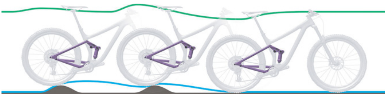
Obr. 144: Příliš pomalé roztahování tlumiče zadního odpružení
