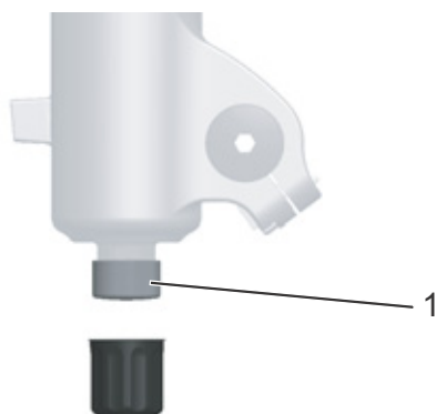
Obr. 92: Nastavovací šroub odskoku FOX (1) na patce nohy vidlice
