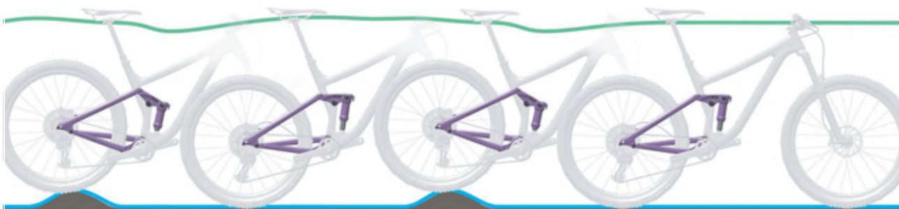
Obr. 89: Optimální chování tlumiče zadního odpružení při jízdě
