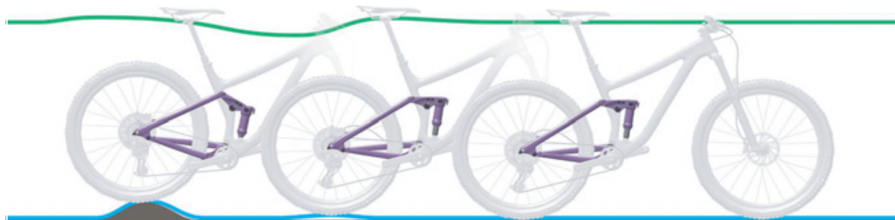
Obr. 142: Příliš rychlé roztahování tlumiče zadního odpružení
