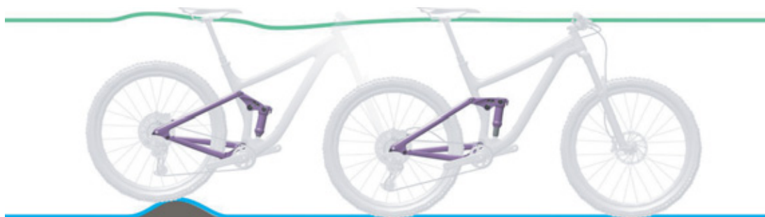
Obr. 12: Optimální chování tlumiče zadního odpružení při jízdě u nerovností
