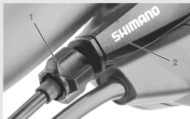
Obr. 131: Seřizovací pouzdro (1) řazení převodů ovládané jedním lankem s řadicí páčkou (2), příklad
