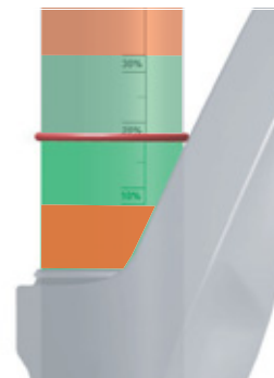
Obr. 85: Předepsaný rozsah SAG (zelený) a zakázaný rozsah SAG
