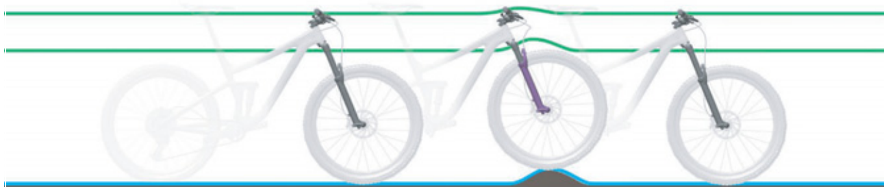
Obr. 7: Optimální chování vidlice při jízdě u nerovností
