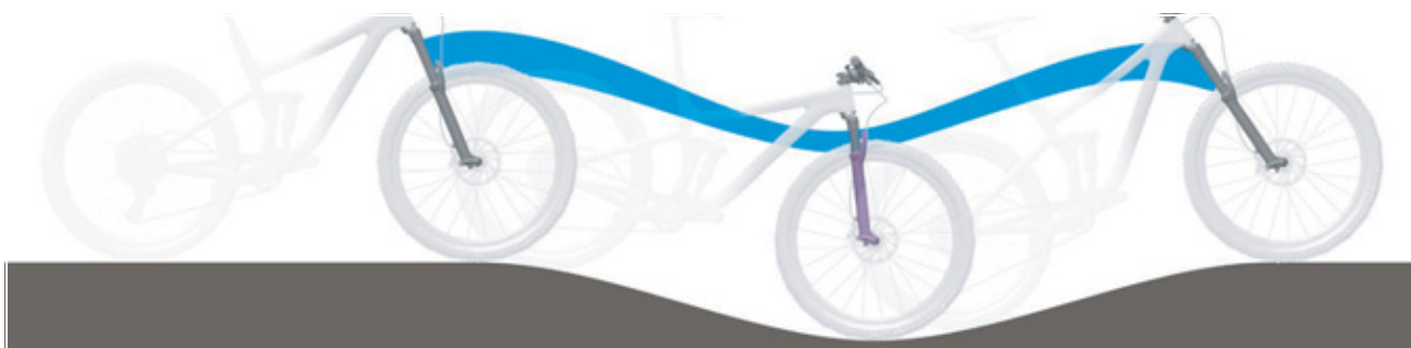
Obr. 138: Příliš měkké odpružení odpružené vidlice v horách
