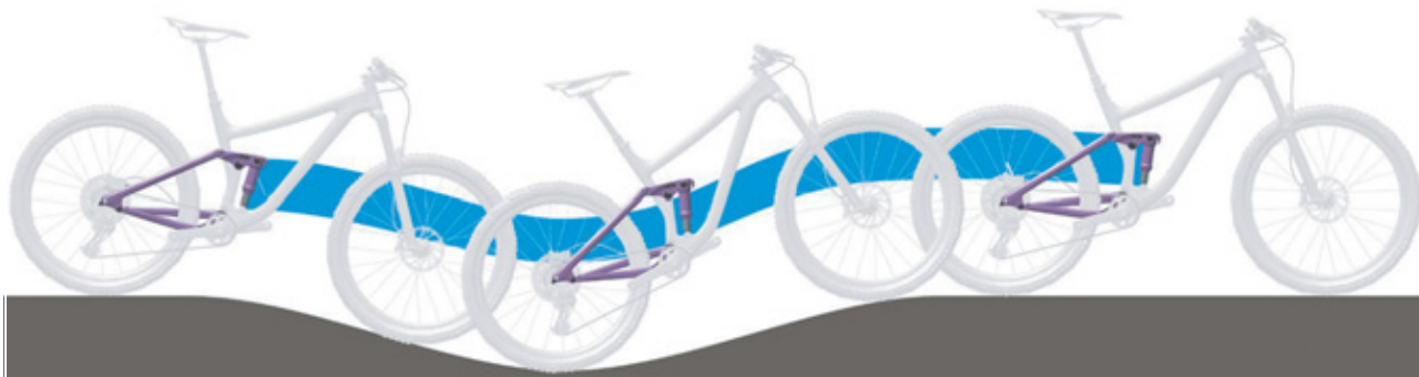
Obr. 97: Optimální chování tlumiče zadního odpružení při jízdě v kopcovitém terénu
