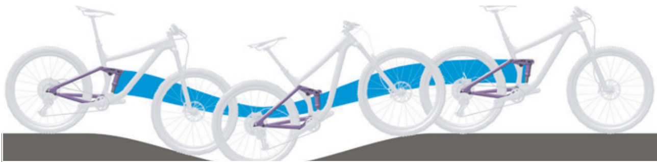
Obr. 146: Příliš měkké odpružení tlumiče zadního odpružení v horách
