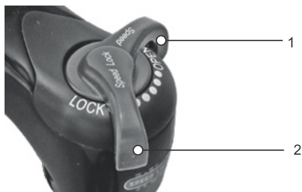
Obr. 122: Tlumič komprese Suntour v otevřené (1) a zavřené (2) poloze
