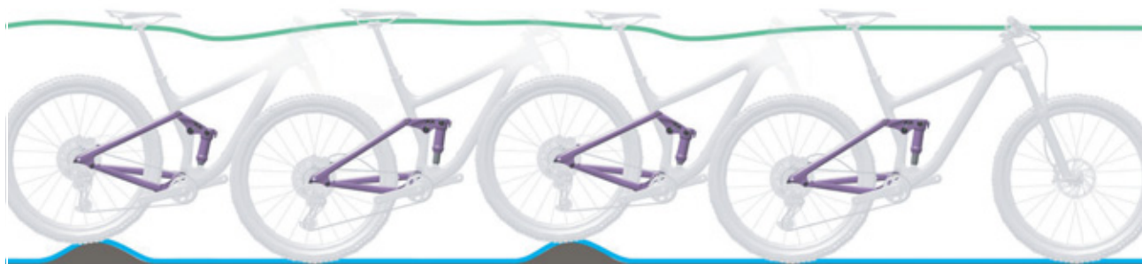
Obr. 10: Optimální chování tlumiče zadního odpružení při jízdě
