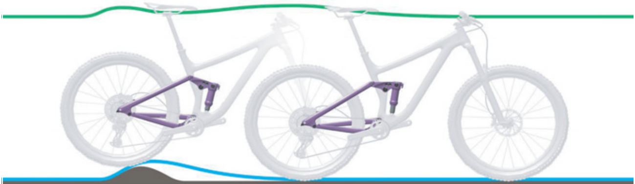
Obr. 148: Příliš tvrdé tlumení tlumiče zadního odpružení u nerovnosti
